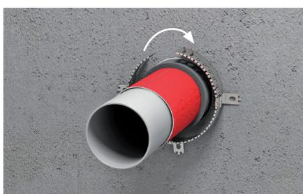
7. A l'extrémité de la bande, repliez deux ergots. Superposez les deux extrémités de la bande de façon à faire passer les ergots au travers et à les replier en position initiale.
