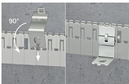
5. A l'aide de l'ergot central de la patte de fixation, repliez à 90° l'onglet de la bande d'acier inoxydable.
