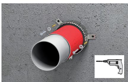
8. Fixez le collier au mur ou au plafond avec les chevilles et les vis fournies. Dans les cloisons légères (plaques de plâtre), utilisez des tiges filetées M6 ou M8.
