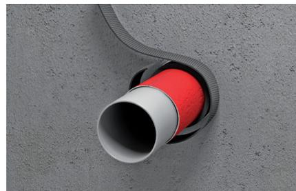
3. Enroulez la bande (adhésif vers l'extérieur) autour du tube ou de l'isolant (vérifiez le nombre d'enroulement requis\*). Fixez avec un recouvrement de 20 mm.
