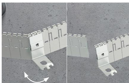
4. Coupez la longueur de bande métallique\* souhaitée à l'aide d'une patte de fixation par un mouvement de va-et-vient, jusqu'à cassure. Aucun outil n'est nécessaire.
