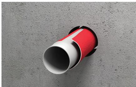
1. Installez le tube et si besoin l'isolant souhaité.
