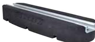
Le pied support BIS Ursus convient parfaitement pour les tuyauteries, les supports de conduits de ventilation, les chemins de câble. Il permet d'installer facilement les appareils de climatisation ou de ventilation en toiture. En caoutchouc vulcanisé résistant aux UV, il contient un segment de rail strut BIS RapidStrut® traité BIS UltraProtect® 1000.
