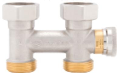
Le by-pass pour circuit primaire (optionnel) permet la séparation hydraulique entre le circuit primaire et le secondaire. Cette séparation hydraulique optimise le fonctionnement du circuit secondaire et empêche que les modifications du débit du primaire influencent le circuit secondaire. Le débit qui passe à travers les circuits dépend exclusivement des caractéristiques de débit
