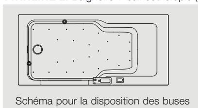
Schéma pour la disposition des buses
