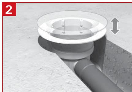
**2** Positionnement en hauteur de la platine du siphon. Pour les versions SITAR et SITARAL, couper la rehausse à la hauteur souhaitée et la coller dans le corps du siphon.
