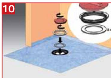
**10** Visser la couronne filetée de bonde dans celle du panneau PSE Haute Densité avec la clé de serrage qui sert de cache anti-débris.
