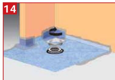
**14** Positionner les joints si nécessaire (cf schéma ci-dessous). Visser le support de grille. Avec bonde verticale : *ne pas ajouter les joints*
