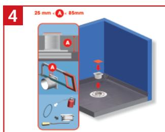
**4** En fonction de la hauteur A de chape à réaliser, couper si besoin le support au ras d'un anneau afin que A soit comprise entre 25 et 85mm. Après la coupe, qui sera bien ébavurée, remonter le joint torique sur la dernière gorge du support. Mettre le support en position dans le corps de bonde, placer, le capot cache débris sur l'ensemble.
