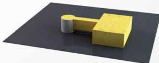
1 - Mettre en place une réservation sur le plancher pour le siphon (tube de Ø200) et pour la culotte (tube ou trémie ouverte).
