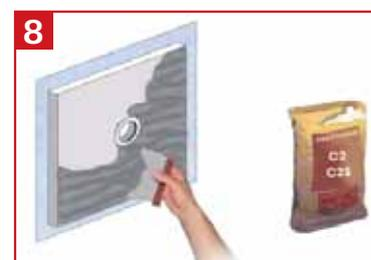
**8** Encoller la face inférieure du panneau PSE Haute Densité à l'aide d'une colle de Type C2 ou C2S.
