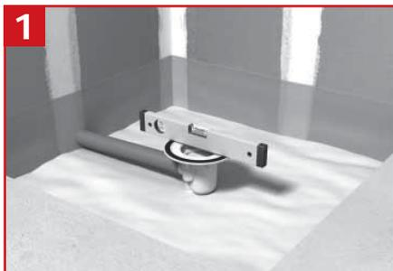
**1** Positionner le corps de siphon de niveau dans la réservation 900 X 900 mm.
