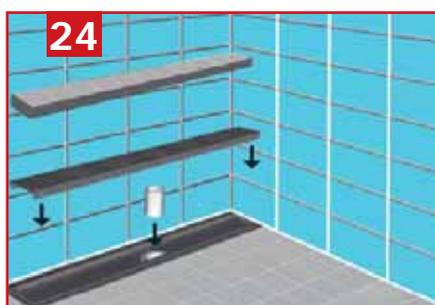
**24** Laisser reposer le carrelage avant de jointoyer et de mettre en charge.
