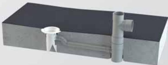
11 - Positionner la sous couche acoustique au ras de la collerette d'étanchéité du siphon
