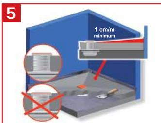
**5** Réaliser la chape de ciment en prenant soin de faire 4 pentes en diamant avec une déclivité de 1% minimum (soit 1 cm/mètre). Ne pas noyer la partie carrée du support mais finir le niveau de la chape juste à sa base. Laisser de la hauteur de film remonter sur les murs (sur 3 à 4 cm).
