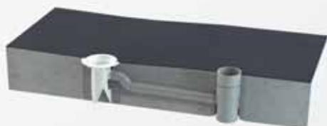
8 - Positionner la sous couche acoustique au ras de la collerette d'étanchéité du siphon.
