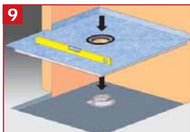
**9** Positionner le panneau PSE Haute Densité puis, affiner sa position à l'aide d'un niveau.
