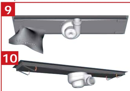
**9** Mettre le caniveau en place et positionner les pieds, sans enlever le film adhésif, de manière à ce qu'ils soient à proximité des pattes de scellement ; tracer au sol la position des embases.
