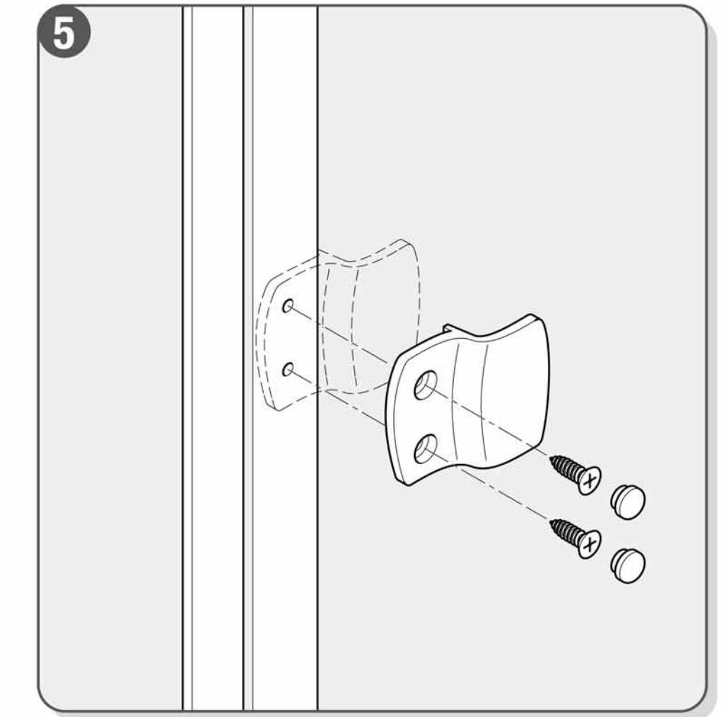
"Prendete una maniglia e fissatela con le viti ø 2,9x4,5 mm al profilo verticale preforato, coprite le stesse con gli appositi tappini. Ripetere la stessa operazione per la seconda maniglia."
