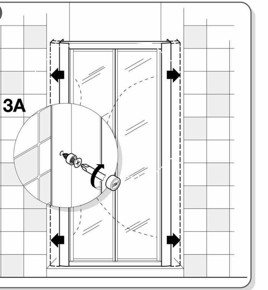
Decidete il senso di apertura (il box è reversibile) appoggiate il box doccia sul piatto con i compensatori inseriti, facendoli aderire lentamente al muro.
