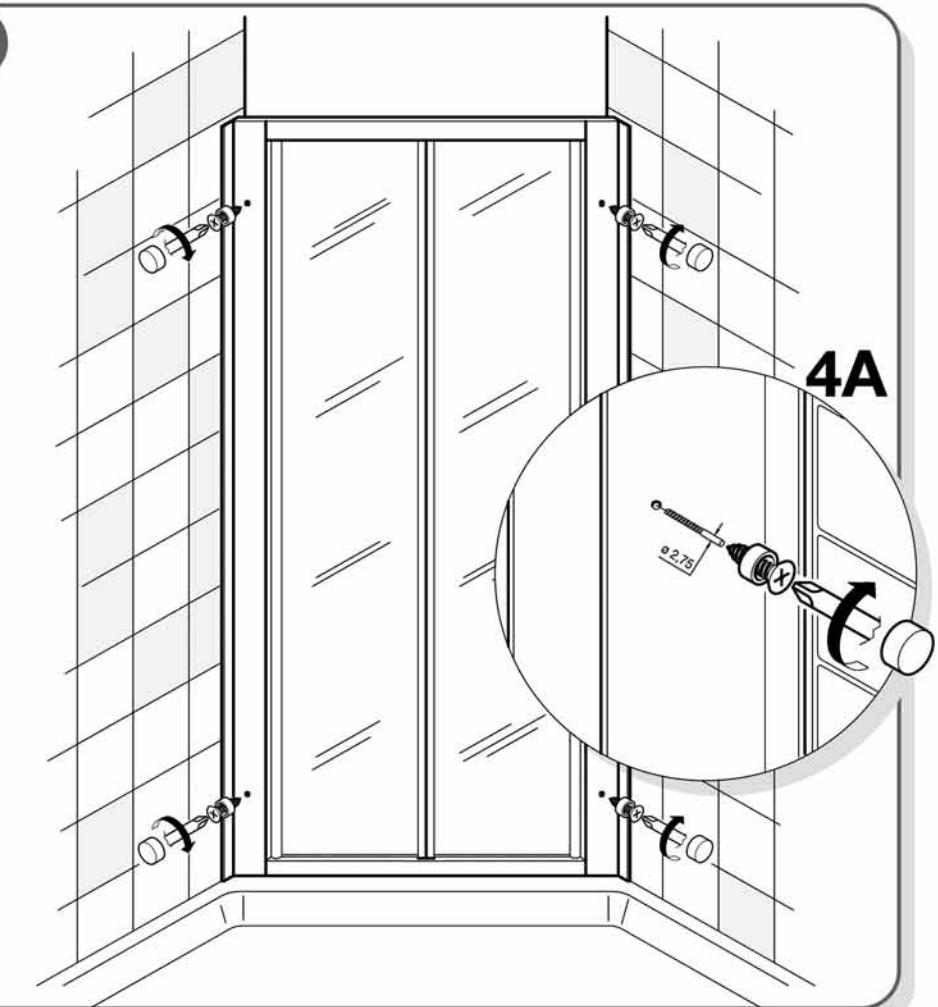
Allineare la porta al centro del vano, controllate che la guarnizione ed il magnete aderiscano ai profili di battuta laterali.
