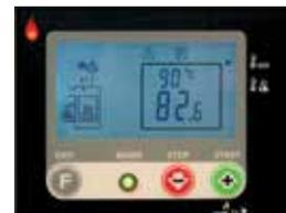
Le tableau de commande standard, avec écran numérique rétro-éclairé, permet de visualiser rapidement les températures de la chaudière et des fumées. L'usage est très convivial grâce au nombre réduit de touches.
