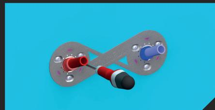
**3** Pousser le kit dans dans les trous de la cloison puis visser les 3 vis de chaque côté. Bloquer sans forcer.
