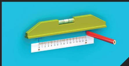
**1** Tracer l'emplacement des trous et percer la cloison à l'aide d'une scie cloche  $\varnothing$  67 mm (réglette d'entr'axe 150 mm sur la boîte).
