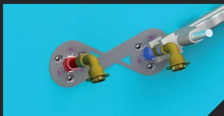
**4** Raccorder les tubes sur les coudes selon le type de raccord choisi.
