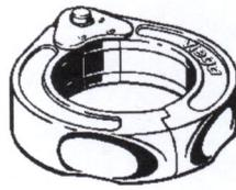
*Figure 3 - Schéma de l'outillage pour réaliser le sertissage des grands diamètres*
